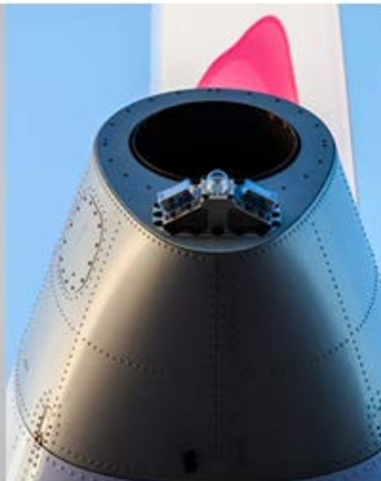
Verrines moulées pour signalisation extérieure sur Airbus A350 Molded lens for signaling of Airbus A350
